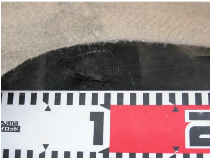
図-2.7 廃棄物掘削作業時に生じた損傷箇所(②:L=4cm)
